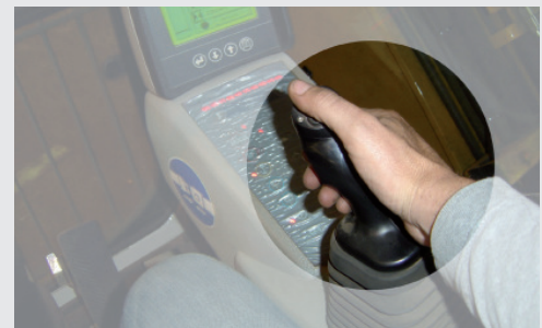
Auslösung der Wägung über einen vorher nicht belegten Taster des Joysticks
