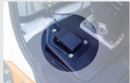
Auslösung der Wägung über Fußschalter
