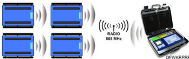
Anwendung mit 4 kabellosen Plattformen und DFWKPRPF Gewichtsanzeige, für die Visualisierung und Druck des Gewichts durch Fernanzeige.
